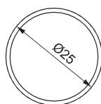
**ŠIPKA** od inox nerđajućeg čelika promera Ø25.
