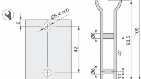
**UGAONICI** izrađeni od INOX-a nalaze se na spojevima panela sa zidom, ili na mestima gde se na uglovima spajaju dva panela. Postavljaju se tri profila po vertikali.
