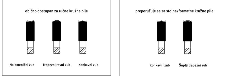
Za rezanje DecoWall panela s ručnom kružnom pilom preporučujemo listove pile s trapeznim ravnim zubima. Ipak, za stolne kružne pile preporučujemo listove pile sa konkavnim zubima ili trapeznim ravnim zubima.
