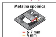
Profilne spojnice za drvo moraju biti pogodne za profile ivica s debeljinom utora od 4 mm i dubinom utora od 6-7 mm.
